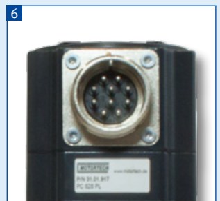
MIL-Stecker zur Anbindung an die VariStep3-Schrittmotorsteuerung
