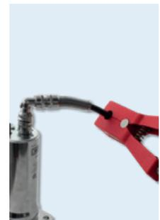
Verwendung mit MOTORTECH-Flanschzündspulen mit Diagnoseschnittstelle oder geschirmtem Primärkabel
